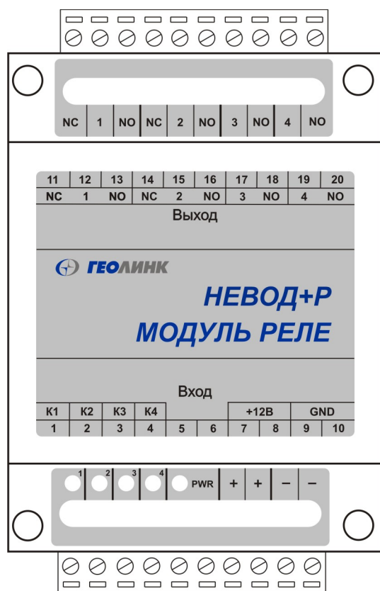
Рис. 1. Назначение выводов клеммных колодок
