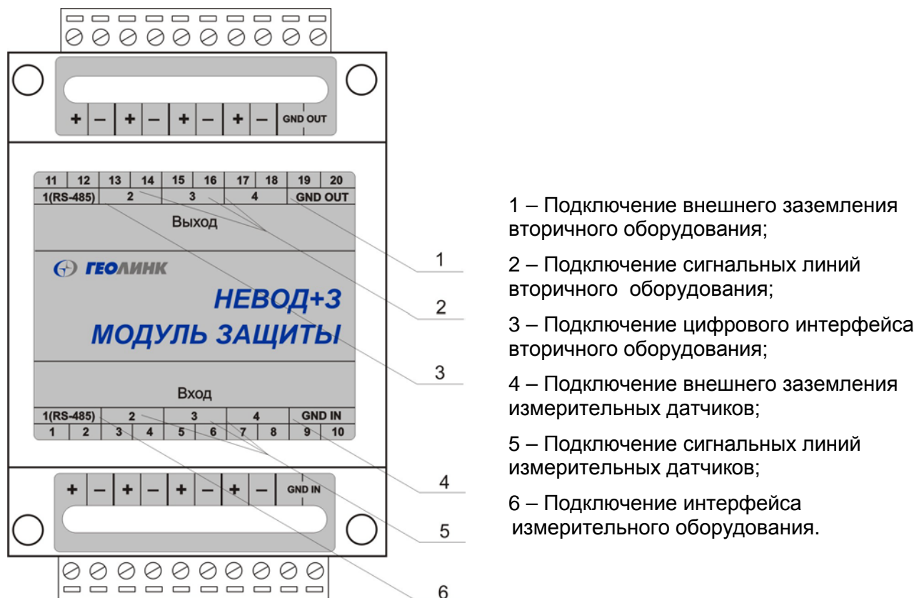
Рис. 1. Назначение выводов клеммных колодок
